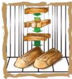
Befeuerungselement auf dem Scheitholz positioniert
