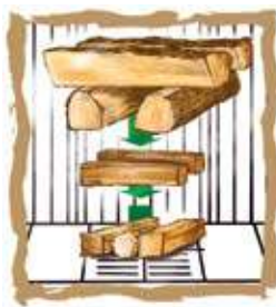
Befeuerungselement unter dem Scheitholz positioniert
